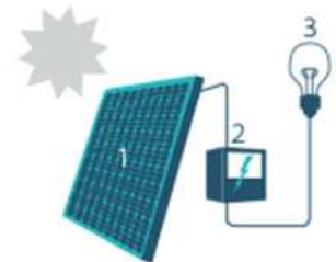
1. Zonnepaneel | 2. Omvormer | 3. Elektrische toestellen
